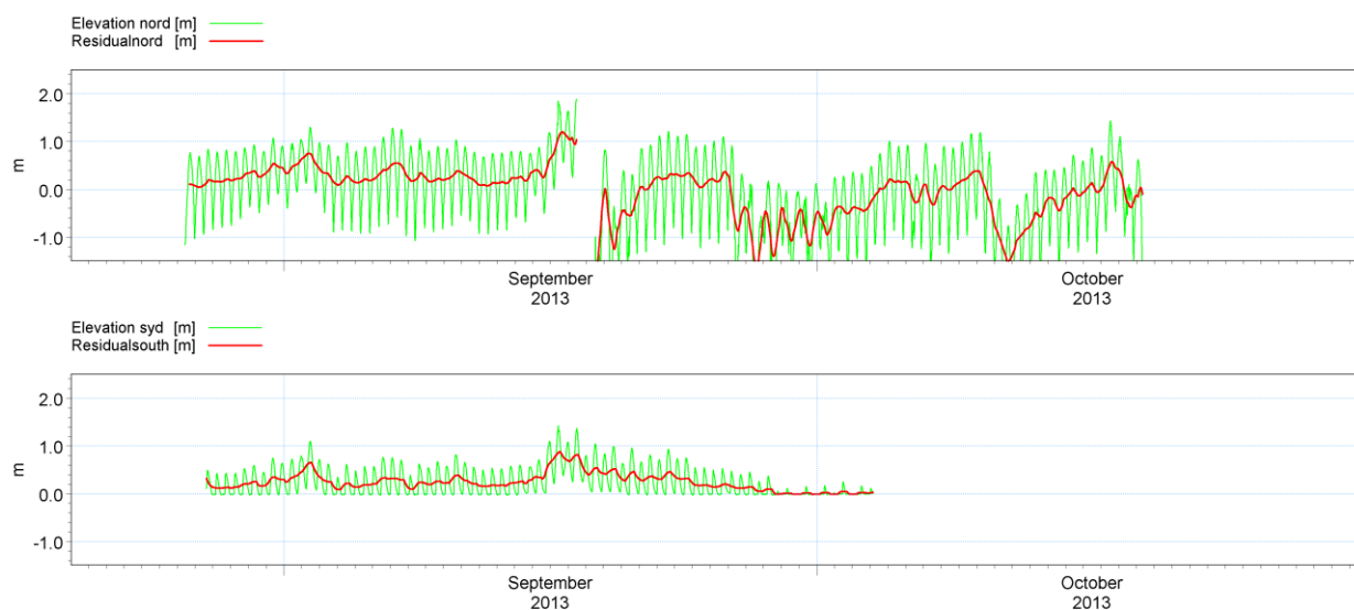
Figur 5-1 Vandstandsmålinger i begge ender af Lundby Løb.
